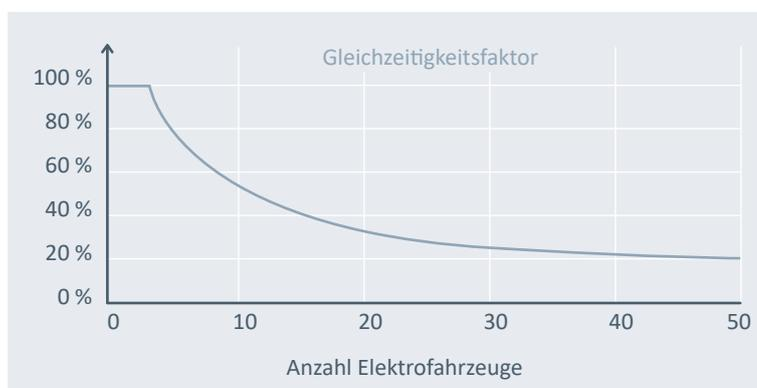
Abb. 7: Beispielhafter Verlauf des Gleichzeitigkeitsfaktors in Abhängigkeit von der Anzahl zu versorgender E-Fahrzeuge (eigene Darstellung, Datenquelle: VDE FNN)
