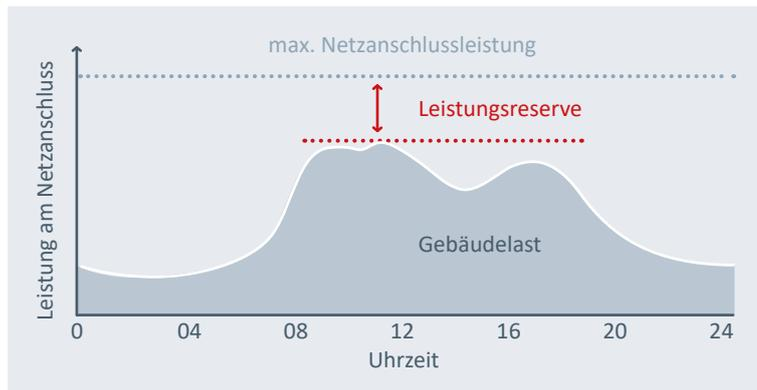
Abb. 6: Statische Leistungsreserve am Netzanschluss (eigene Darstellung)
